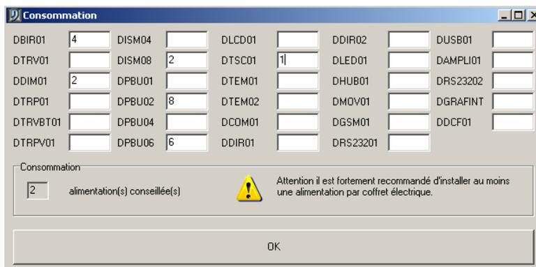
Toutefois, si l'installation se compose de plusieurs coffrets électriques, il est nécessaire d'installer au moins un module d'alimentation par coffret. Et ce même si l'outil de calcul ne conseille qu'un seul module.
