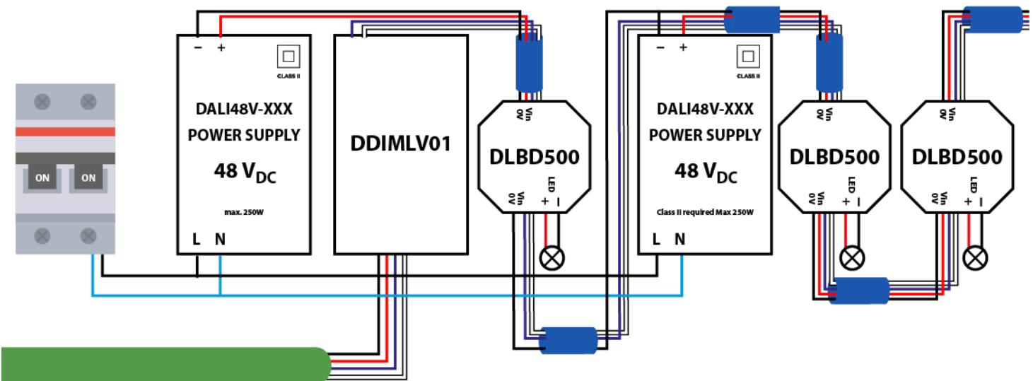
Het aantal benodigde voedingen moet worden berekend aan de hand van het maximale vermogen van de voedingen en het totale vermogen van de lampen.
