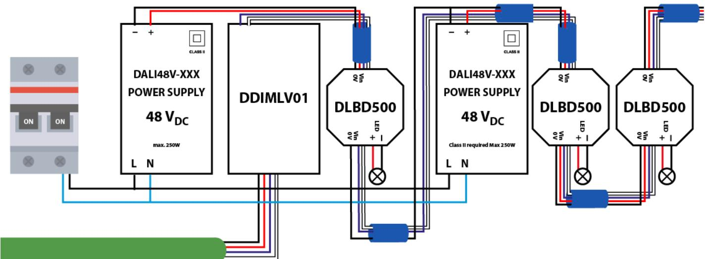
Le nombre d'alimentations nécessaires est à calculer en fonction de la puissance maximale des alimentations et de la puissance totale des lampes.
