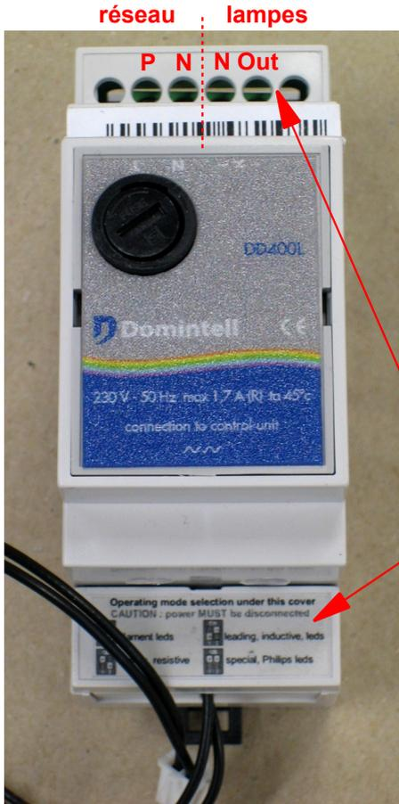
Le DD400L est un module dimmer, destiné à être raccordé dans un système Domintell sur un module DDIM01, et conçu pour une installation en armoire sur rail Din dans les réseaux électriques 230V AC 50 Hz.
