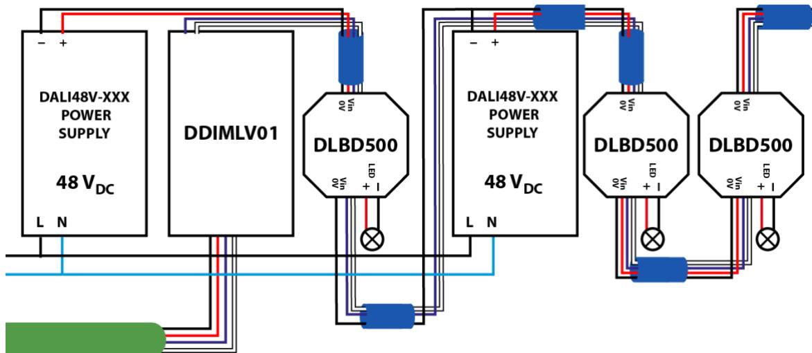
Het aantal benodigde voedingen moet worden berekend aan de hand van het maximale vermogen van de voedingen en het totale vermogen van de lampen.
