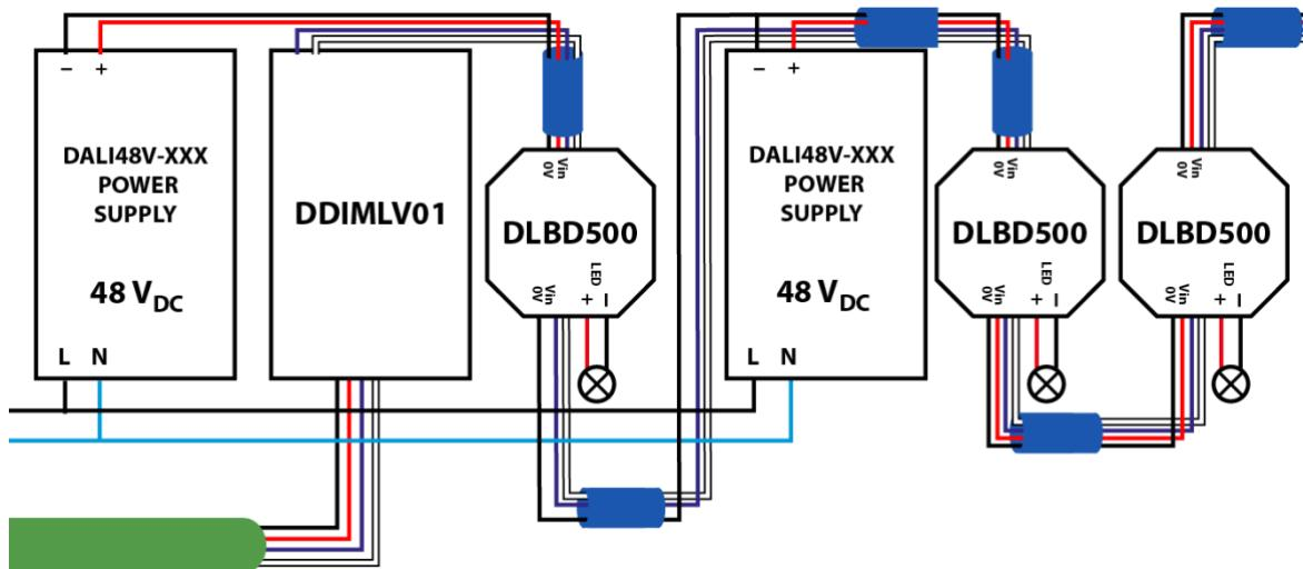
Le nombre d'alimentations nécessaires est à calculer en fonction de la puissance maximale des alimentations et de la puissance totale des lampes.
