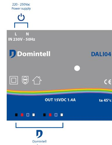
In geval van gebruik van meerdere DALI0x voeding modules (ongeacht het model) in dezelfde Domintell installatie, moeten ALLE ZWARTE draden (0 VDC = GND) met elkaar verbonden worden, maar de RODE draden (+VDC) van een DALI0x mogen NIET worden aangesloten op een andere DALI0x (direct of indirect). D.w.z. dat de modules verbonden met de rode draad aan één DALI0x voeding geen spanning kunnen en mogen krijgen van de andere DALI0x voedingen.
